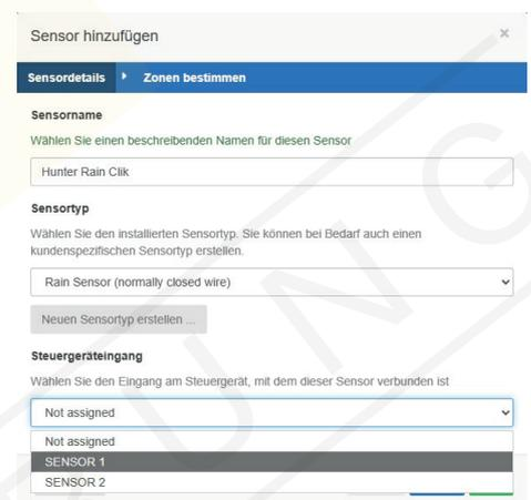
Wählen Sie die Sensorklemme an die Sie den Sensor angeschlossen haben.
