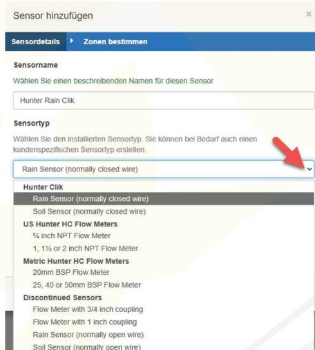
Den entsprechenden Sensor wählen. Hunter Sensoren sind immer „Normally closed!“
