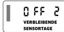
Eine aktive Klik-Verzögerung kann beendet werden, indem Sie den Drehschalter auf AUS stellen und warten, bis AUS nicht mehr blinkt. Stellen Sie anschließend den Schalter wieder auf die Position **BETRIEB**.
